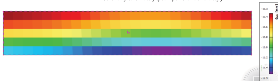
Normově závislý průhyb balkónové desky
